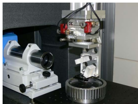
図1 超高精度平面度測定装置（SDP）の概略図（左）とその外観（右）
